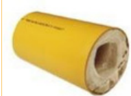
TUBERÍA CON SARRO INCRUSTADO
